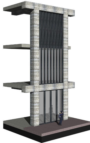
stijlen 65 x 300mm - basis vlakverdeling 4 stuk - gradaties in transparantie - integreren van vloerlijn in het kozijn
