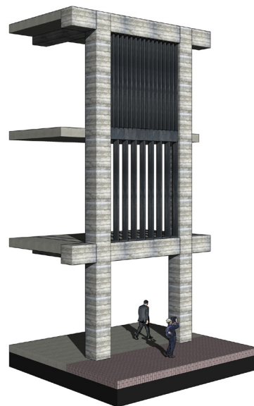
stijlen 65 x 300mm - kozijn in 1 vlak - vloerdikte zichtbaar in kozijn
